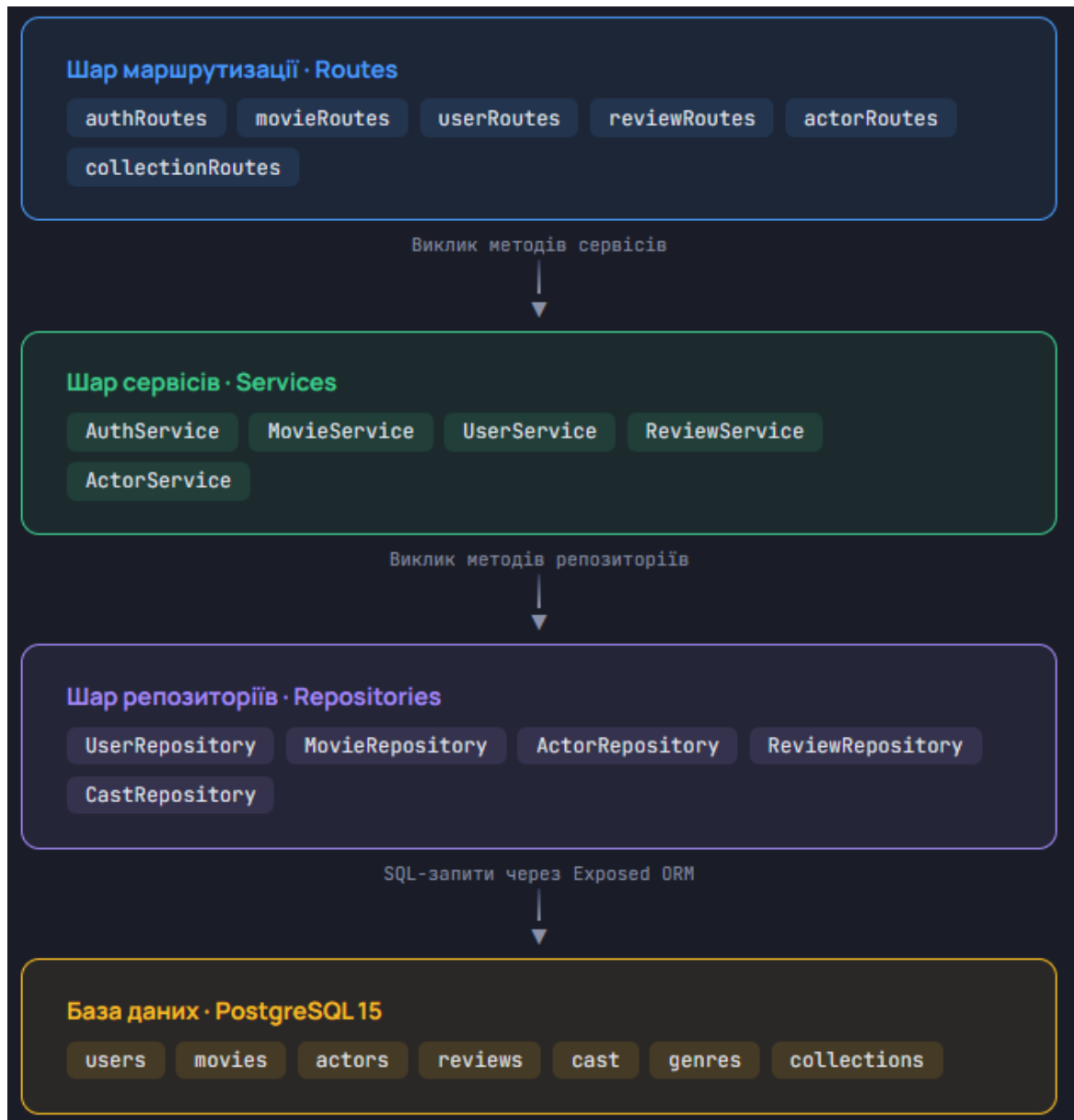
Рис. 2.4. Діаграма шарів архітектури (Layered Architecture)
